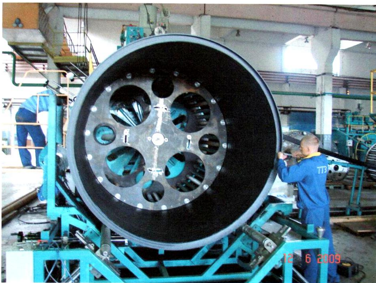
Рисунок 3.1 – Технология производства труб «Спиралайн»
